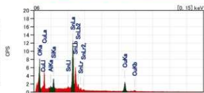
第197図 金属製品(Sn 1)のSEM-EDS分析結果
