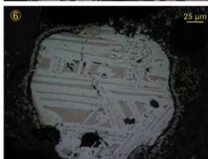
図版 14 炉壁・製錬滓(ガラス質滓)の顕微鏡写真
