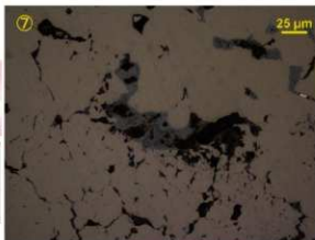
図版 12 製錬滓(ガラス質滓)・鍛冶滓片の顕微鏡写真
