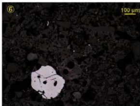
図版 13 鍛冶滓片・炉壁の顕微鏡写真
