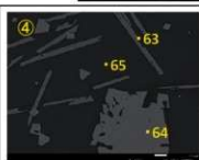
滓部の反射電子像 (COMP)・特性X線像
