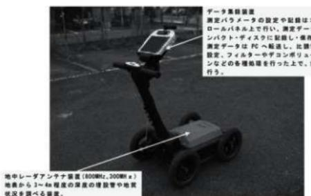
第190図 2.2 地中レーダ探査測定装置 (DF型)
