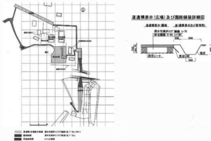
図59 舗装範囲図・断面図
