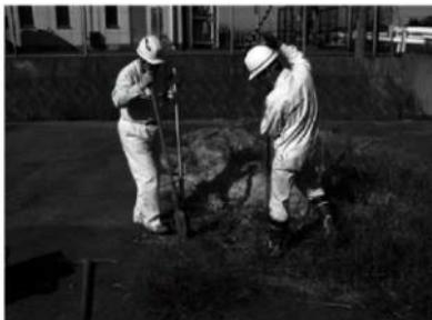
写真1 土壤検査のための試料採取
