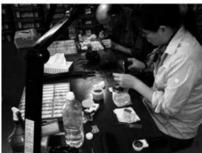
写真13　樹種同定のための切片採取作業
