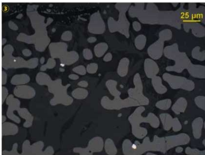
図6 TTS-5 鍛冶滓 顕微鏡組織図
