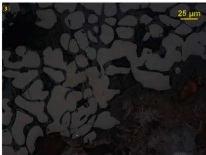
図5 TTS-4 鍛冶滓 顕微鏡組織図
