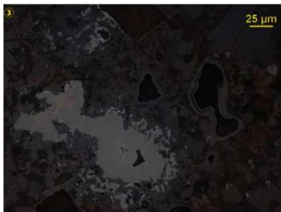
図1 TTS-1 桃形鍛冶滓 顕微鏡組織図
