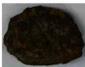
①～③滓部：92.9(1)・77.9(4)、微小白色粒：金属鉄、不定形青灰色部：錆化鉄
