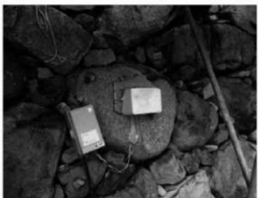
第8-52図 ひずみゲージ防護箱
