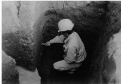
山中式簡易土圧計による検査
