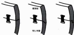
第3-57図 準構造船緊縛方法模式図（柴田2017より引用一部改変）
