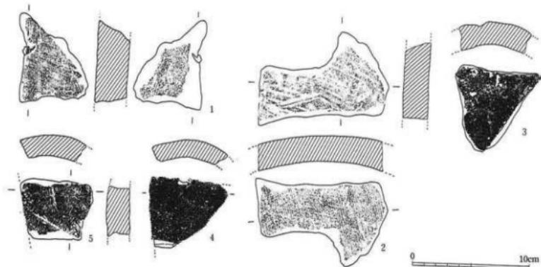
第31図 建物4（1・2）、B区1層（3・4）、B区2層（5）出土瓦実測図
