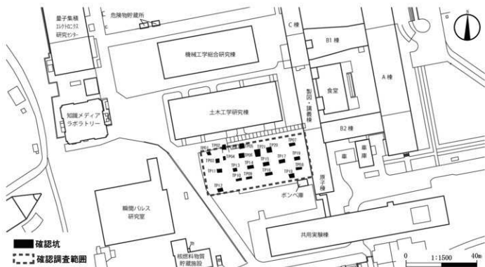
図 59 工学部資源棟新営工事予定地における調査坑
