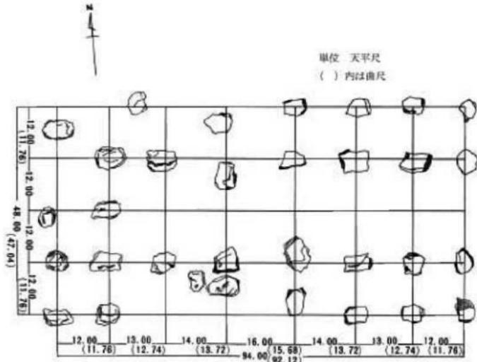
第3図 金堂規模復元図（約1：250、方位は磁北）
