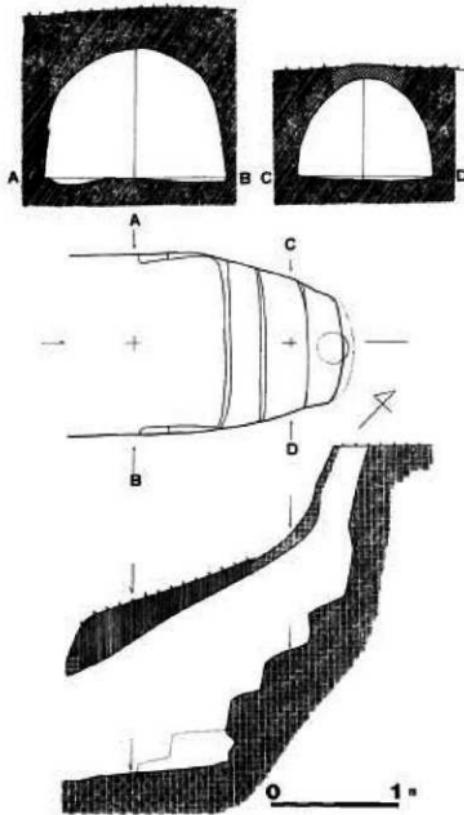
第2図 有段窯実測図
