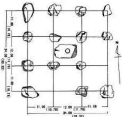
第4図 塔規模復元図（約1：200、方位は磁北）
