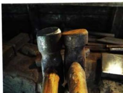
図2 金鎌におけるカガミ面の傾斜の違い
