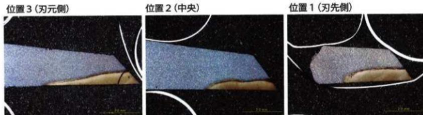
図23 試料採取位置による鍛接部マクロ組織の違い（鉄A）
