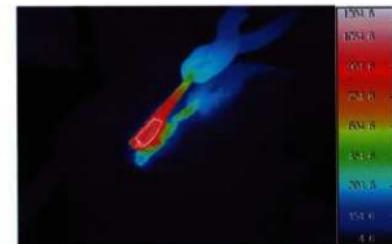
1-2 鍛接面の酸化膜除去 — 987°C
