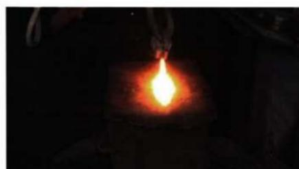
2-6 錛接（強打）、鍛造（アラヅクリ） — 1210°C
