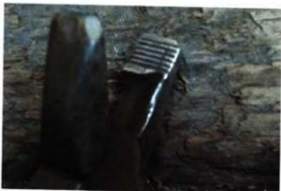
図15 ウデの調整用に変形させたベンチ
