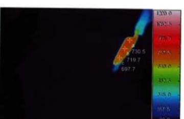
図8 工程③鍛造加工終了時の熱画像
