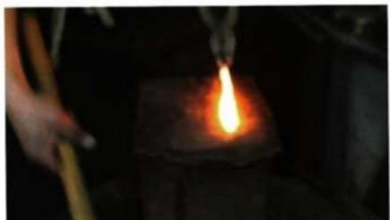
3-9 稠先端の鍛接（外形の成形を含む）— 1070°C
