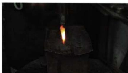
4-13 鍛造（水打ち、穂各部の均し） — 922°C
