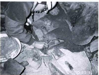
基底部石材の勾配測定
