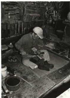
写真23 桶側を漆で削る（日田市）
