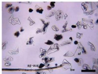
図 1 火山灰試料の偏光顕微鏡写真。下方ポーラのみ（オープンニコル）。
