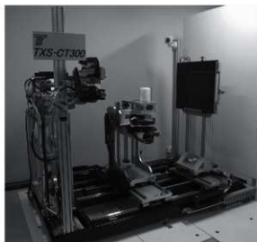
第1図 福島県ハイテクプラザのX線CT装置
