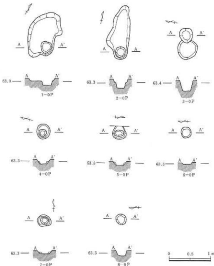
第37図 第1地区平安時代ピット平面図・断面図
