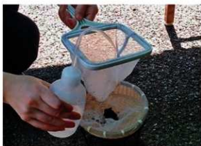
⑫漏れ取りネットに回収した浮遊物は、底の方に水をつかってまとめ、裏返して、三角コーナーのネット（ストックングのように目が細かいもの）を2枚重ねた中に移動させる（この作業時なるべく水を使わないようにする）。
