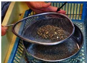
②粗い目のフルイを細かい目のフルイの上にし、乾燥フルイがけをする（乾フルイ法）。
