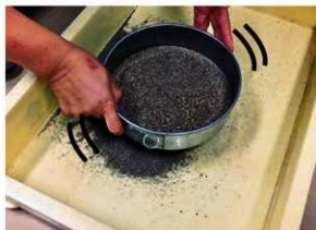
⑤0.5mm 目のフルイを使ってフルイがけをする。フルイを通った沈殿物はバケフに入れ、廃棄する。
