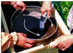
⑧フルイからの落下物がほぼなくなったら、フルイの中の残渣を水の力とフルイの振動を利用してフルイの片側に寄せる。
