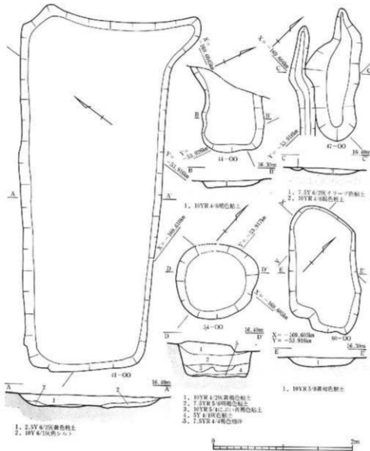
第68図 41・44・47・54・60-OO 平面図・断面図 (1/40)
