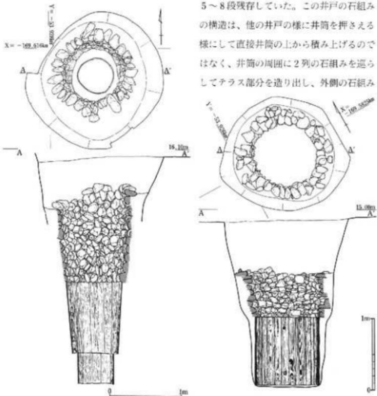
第47図 606-OW 平面図・立面図 (1/40) 第48図 625-OW 平面図・立面図 (1/40)
