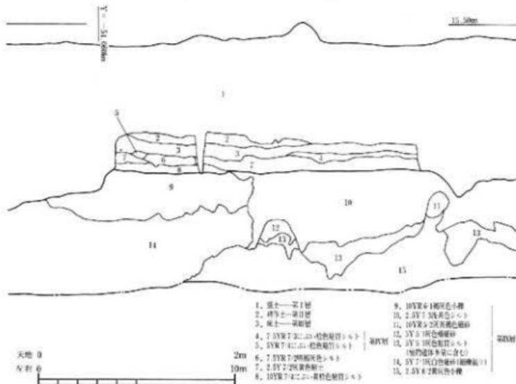
第8図 IV区土層断面図(天地1/40、左右1/200)
