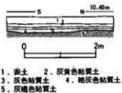
第89図 T-4断面図 ( $S = 1/80$ )
