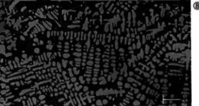
写真26 №5、6鉄滓(桃形鍛冶滓・KHU-5、6)の顕微鏡組織
