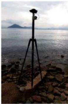
図 14 海岸の石材を RTK-GNSS で位置測定
