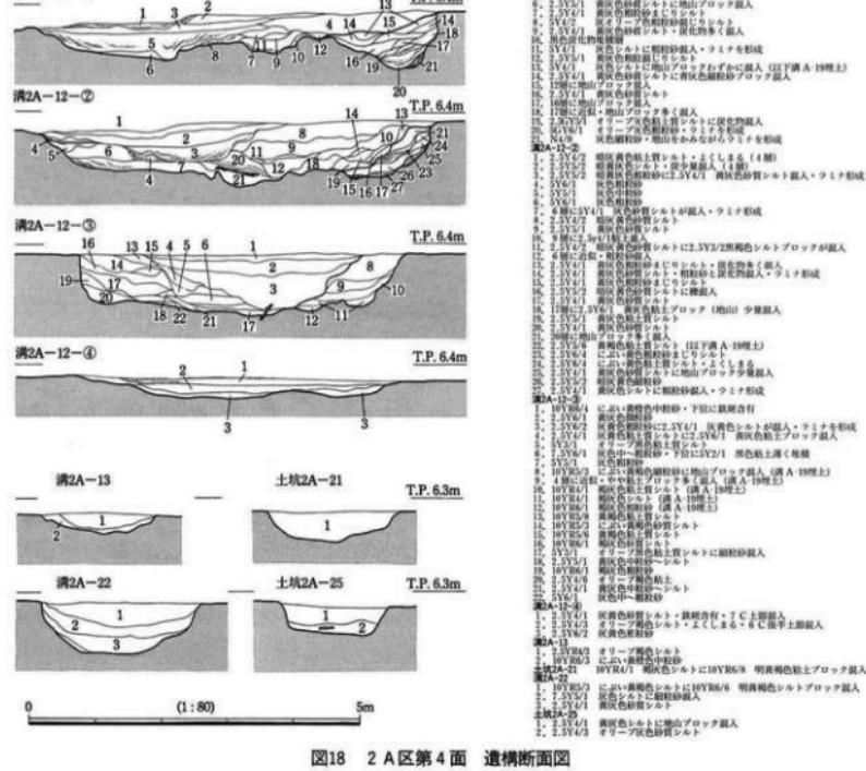
図18 2 A区第4面 造構断面図
