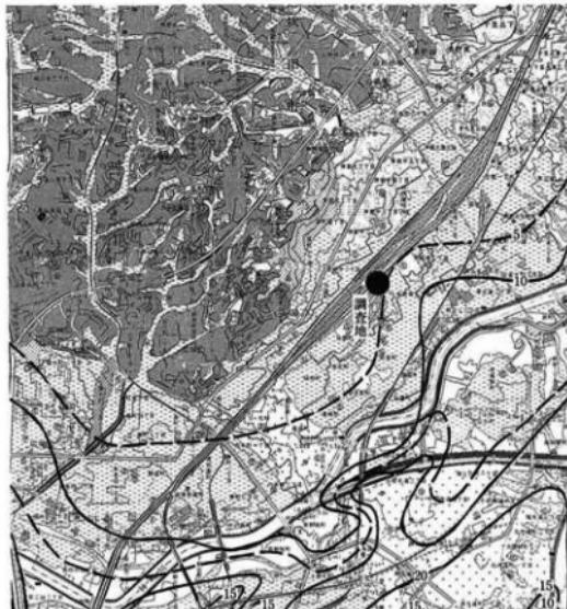
図87 沖積層基底面等深線(土地条件図より作成 5万分の1)
