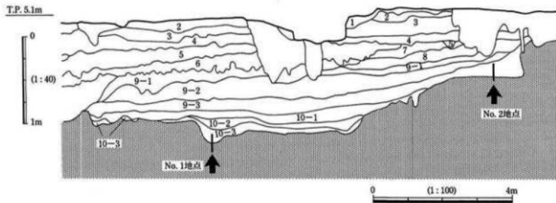
図83 火山灰分析試料採取地点 断面図-1
