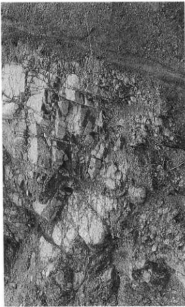
写真9 花崗岩の破碎状態
