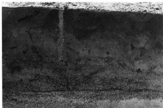
写真7 砂脈の断面形態（図436の左半分）
