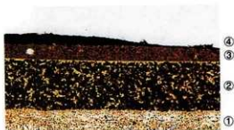
①赤褐色系漆 ②朱漆(粗) ③朱漆(細) ④黒色絵漆 (透過写真：×400)
