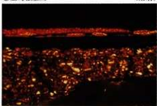
①サビ下地 ②黒漆 ③赤褐色系漆 ④朱下絵漆+金梨子地加飾 ⑤朱下絵漆+金蒔絵加飾 (落射偏光)
