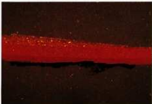
①炭粉下地 ②ベンガラ漆 ③朱漆 ④石黄加飾 (落射)
