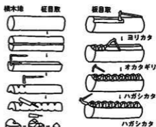
2 近世会津木地師の木取りの方法 (横木抜男『日本人の生活と文化(本) 暮らしの中の木器』-1982-より原図引用)
