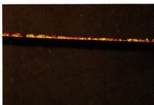
①炭粉下地 ②赤褐色系漆 ③石黄加飾 (落射)
