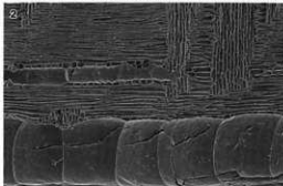
試料番号1 (トネリコ属, 径目面, 58倍, 年輪境界を含む。同放射組織)
