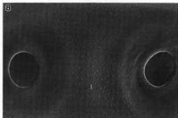
試料番号5 (モミ属, 径目面, 2600倍, いぼ状突起と壁孔)
