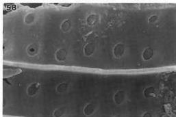
試料番号158 (モミ属, 板目面, 1000倍, スギ型分野壁孔)
