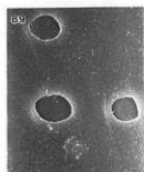
試料番号SH-8.14 (スギ, 板目面, 1500倍, スギ型分野壁孔)
