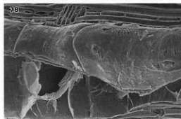
試料番号99 (クルミ属, 板目面, 150倍, チロース, 単せん孔)
