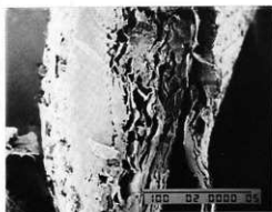
写真16 藁(現代)の断面の 走査型電子顕微鏡写真 (×500)
