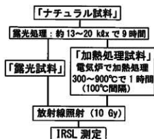
第26図 IRSL 感度変化法による被熱温度推定の測定手順
