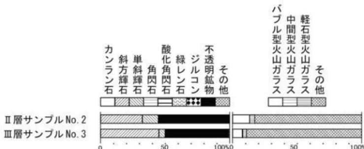
第A図 深掘土層序断面の重鉱物組成および火山ガラス比
