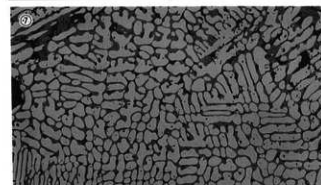
写真図版442 鉄滓の顕微鏡組織
