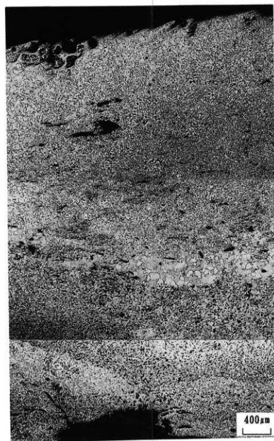
刃先先端から 30mm 断面 (×25)
