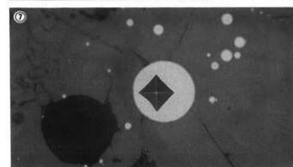
写真図版401 増場内面溶融物の顕微鏡組織
