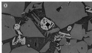
写真図版425 鉄滓の顕微鏡組織
