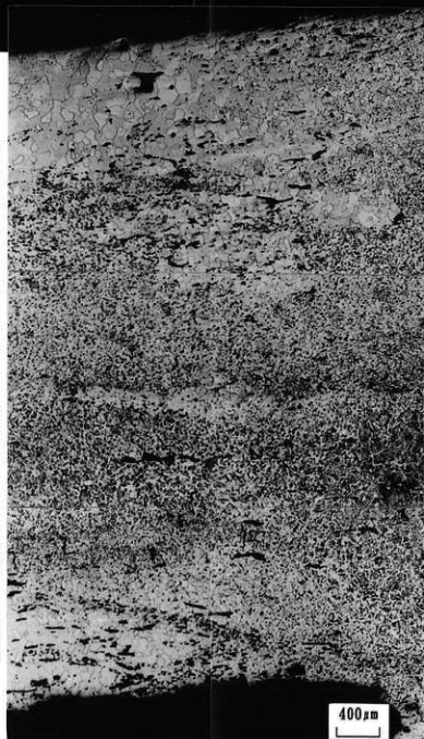
刃先先端から 20mm 断面 (×25)
