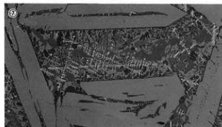
写真図版430 鉄滓の顕微鏡組織
