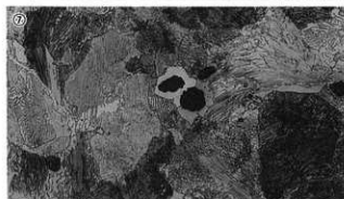
写真図版424 鉄片入り鉄滓の顕微鏡組織
