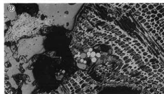
写真図版404 鉄滓（鍛冶滓）と溶解炉炉壁の顕微鏡組織
