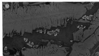
写真図版426 鉄滓の顕微鏡組織
