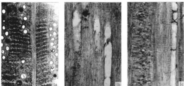
図9.1 木材(コナラ属アカガシ亜属)切片の顕微鏡写真
