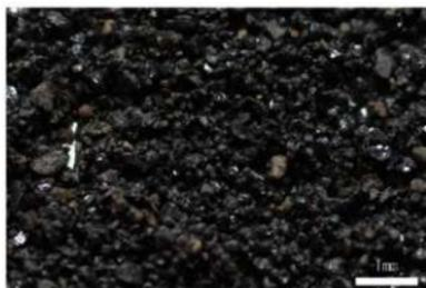
3. 磁鉄鉱を主とした磁性鉱物
