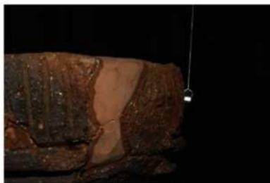
1. 吊した磁石による磁性の確認
