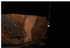
1. 吊した磁石による磁性の確認
