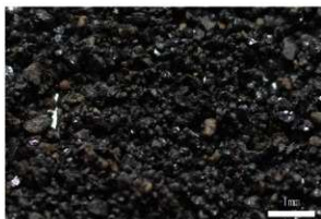
3. 磁鉄鉱を主とした磁性鉱物
