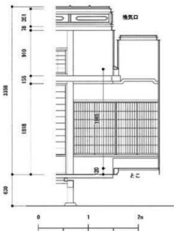
図 3-13 奥座敷床詳細図（作図：設計衆団 LN）
