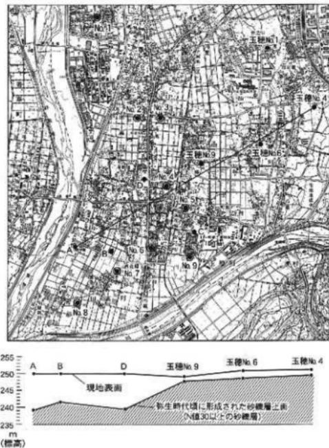
第4図 試掘坑設定地点と既存データの位置(1/50,000)および地下断面推定図(平面方向1/50,000、水平方向1/1,000)
