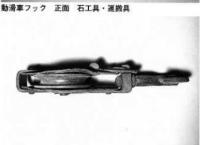
動滑車フック 側面 石工具・運搬具
