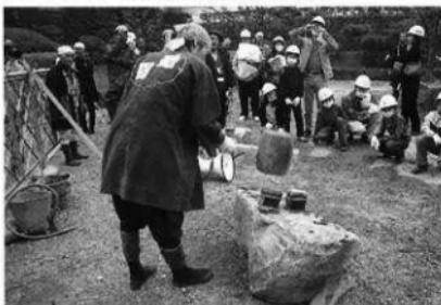
木製の矢（4寸幅）による割石実験
