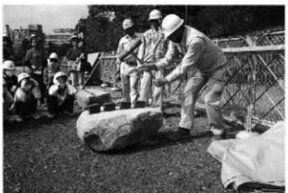
鉄製の矢（4寸幅）による割石実験
