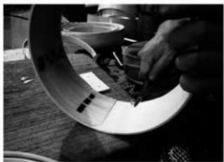
網を張ったときに、網がピンと張るように、親輪のクチ（円周の縁）の内側部分を小刀で削る。これは木の台に親輪を載せ、左手で親輪を支えながら右手で内側を削るという姿勢になる。
