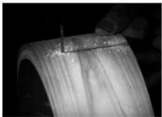
2つの重なった曲輪にドリルで穴をあけ、銅線を通して、金床の上で銅線を金槌で叩いて曲げて固定する。銅線は数か所固定する。これで中華蒸籠の下枠が完成する。
