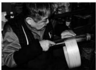
規定の直径にあわせて重ねた曲輪の原材料の端に、ワッコハサミを挟む。重ねた部分にはすでに木工ボンドを塗っている。
