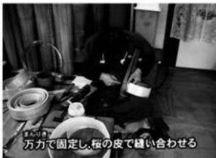
万力で留めた枠を腿の上にのせて左手で支え、右手で目ざしを持って曲輪の枠の重なったところに一文字の穴をあける。
