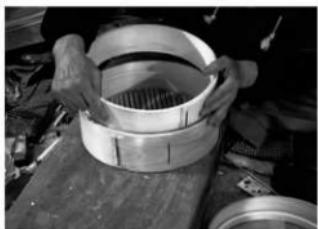
曲輪をひっくり返し、下枠の子輪になる枠をはめ込み、大小2つの曲輪が入れ子に重なった状態となって、スダレが固定される。
