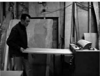
4. 材料の厚みを取る（自動鉛盤）
