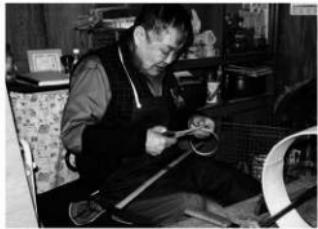
綴じる穴の幅に合わせて、PPバンドを細く裂く。かつては桜皮で綴じていた作業であるが、桜皮の量を確保しにくい状況であることと、桜皮よりPPバンドの方が丈夫で長持ちするため、現在はもっぱらこれを使用する。
