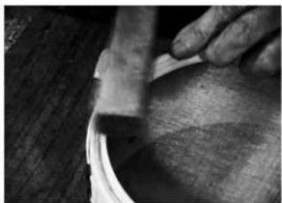
二の子輪は、一の子輪と同様に、打ち棒で緩みなく打ち込んでいく。この時点で、金網がピンと張って固定される。
