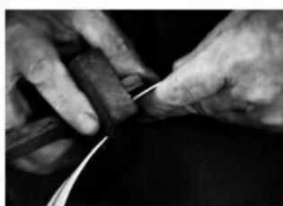
小刀で角を切り取った枠の端から 2 センチ程度のところに、墨引で線を引く。墨引は枠を打ち込んで刃を留めているが、この線を引く幅は決まっているのではば固定である。
