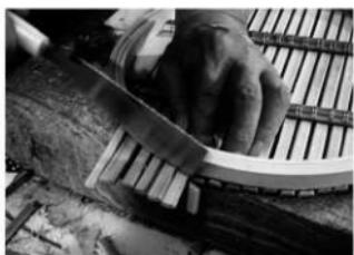
下枠の親輪の底に、スダレをはめ込む。子輪をはめ込む要領で、木の台の上で打ち棒を使って叩きこんでいく。
