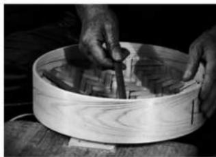
この二枚の網代を、親輪の直径よりも少し長い竹で突っ張るようにして固定する。
