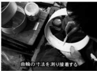
曲輪の枠の両端の重なった部分の幅の分だけ、木工用ボンドを塗る。
