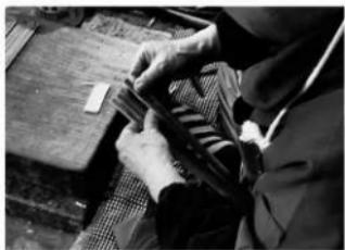
割った竹の端を下枠の底に平行に渡した竹と直行してならべ、銅線で縛るように編んで、一本一本固定していく。
