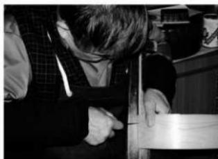
ワッコハサミで挟んだすぐ横に、メザシで穴を開ける。原材料が硬くなっていると、この作業に力が要って大変になる。材料を仕入れたあと、注文がないなどの事情で製品作りまで時間があくと、原材料が硬くなる。
