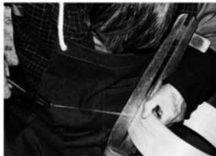
裏から通したバンドが通りにくいときは、端をベンチではさんで引き抜く。曲輪製作の作業場に金網製品製作用具もあるため、使える道具は何でも転用、活用する。
