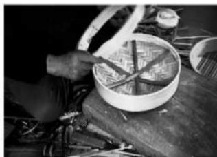
蓋の親輪の内側に木工用ボンドを塗り、子輪のように内側に一回り小さい曲輪材を入れ、木の台の上で打ち棒で叩きこむ。
