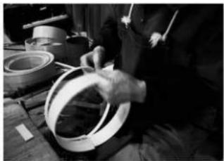
新たな曲輪のヒノキ材から、子輪を切り出す。これは材料の端を3センチほど薪引で削って、細長い材料を2本切りだす。子輪は親輪との間に網を挟んで固定するための材料である。
