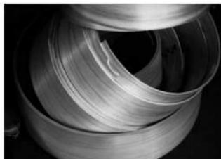
曲輪の枠の材料は、奈良県桜井市大字桜井の勝山曲輪製作所でヒノキ材を使用している。材はいわゆる「吉野ヒノキ」である。ヒノキ材を薄く加工し、あらかじめ丸めた形をついたものを購入する。
