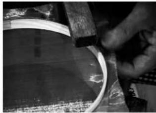
クチの内側に先ほど切り取った子輪をはめ込む。この子輪を「一の子輪」と呼ぶ。親指で子輪をある程度押しこみ、右手の親指の付け根で、槌のように上から叩きいれる。
