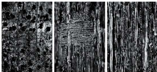
横断面 ————— : 0.4mm 放射断面 ————— : 0.2mm 接線断面 ————— : 0.2mm 12. SA16 C4 垂木 エゴノキ属
