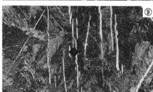
写真3 含鉄楕形鍛冶滓の顕微鏡組織
