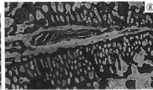
写真12 炉壁 (鉄塊貫入) ・鉄塊系遺物の顕微鏡組織
