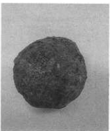
AMS-30-3 鉄塊系遺物 (鋳鉄片) ⑥×100 錳化鉄： 片状黒鉛・パーライト組織 ねずみ鋳鉄痕跡 ⑦×100・⑧×400 同上
