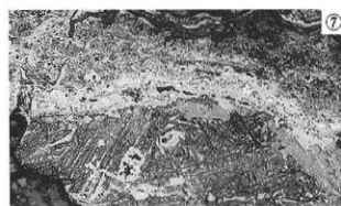
写真16 鉄塊系遺物の顕微鏡組織
