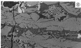
写真7 梶形鍛冶滓の顕微鏡組織
