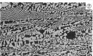
写真13 三日月状鉄製品の顕微鏡組織
