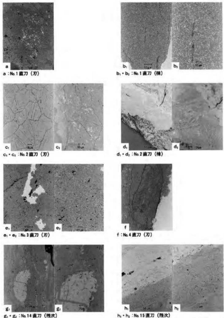
図3 鉄器から採取した試料片のミクロ組織 (その1)
