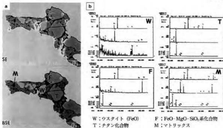
図9 No.9 鉄錆状鉄製品から採取した試料片にみいだされた非金属介在物1の2次電子像と反射電子像、EPMAによる定性分析
