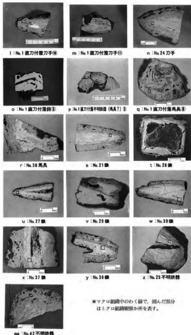
図2 鉄器から採取した試料片のマクロ組織（その2）
