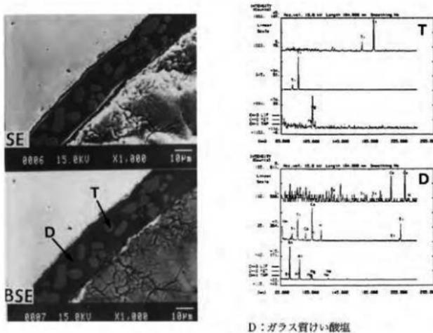
図13 岩手県浄法寺町飛鳥台地Ⅰ遺跡出土紡錘車にみいだされる非金属介在物の2次電子像と反射電子像、EPMAによる定性分析
