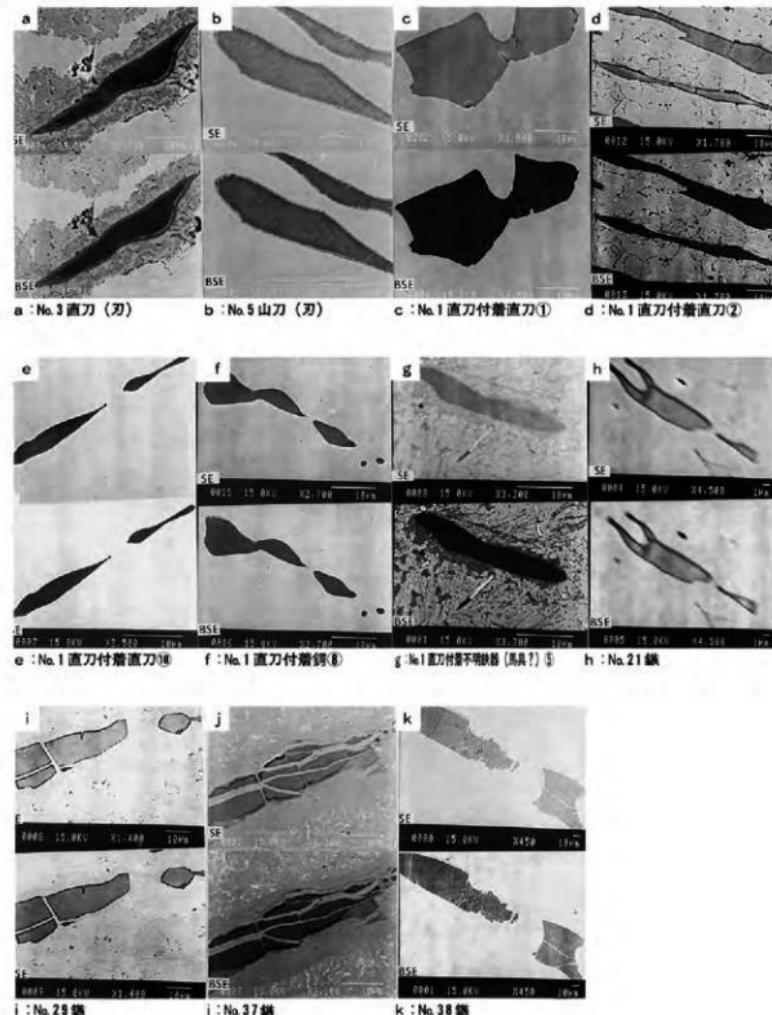
図7 ガラス質けい酸塩からなる非金属介在物の2次電子像と反射電子像
