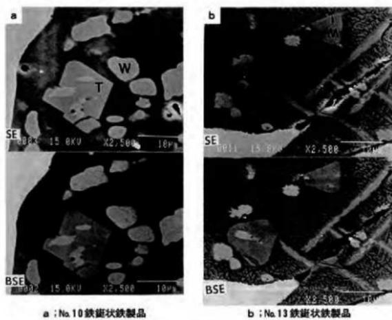
図10 No.10, No.13鉄錆状鉄製品から採取した試料片にみいだされた非金属介在物の2次電子像と反射電子像
