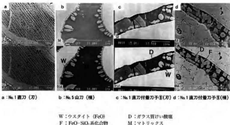
図9 ウスタイト、 $\text{FeO}-\text{MgO}-\text{SiO}_2$ 系化合物、ガラス質けい酸塩もしくはマトリックからなる非金属介在物の2次電子像と反射電子像
