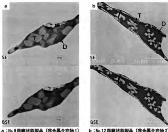
図 8 No. 9, No. 12 鉄基状鉄製品から採取した試料片にみいだされた非金属介在物の 2 次電子像と反射電子像
