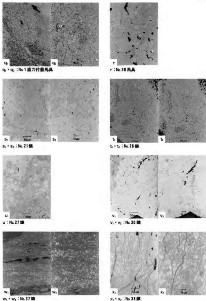
図3 鉄器から採取した試料片のミクロ組織（その3）
