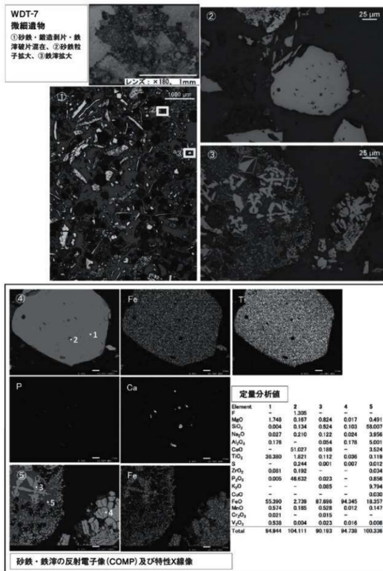
写真21 微細遺物の顕微鏡写真・EPMA調査結果
