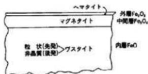
第268図 鍛造剥片3層分離型模式図
