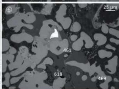
写真20 椀形鉄治滓の顕微鏡写真
