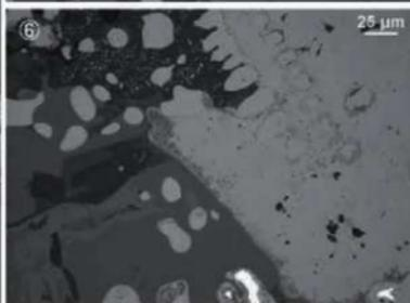
写真19 椀形鐵冶滓・鐵冶滓の顕微鏡写真
