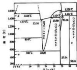
第269図 Fe-O系平衡状態図
