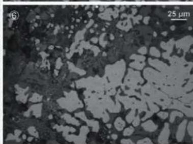
写真18 製錬滓 (炉内滓)・椀形鍛冶滓の顕微鏡写真
