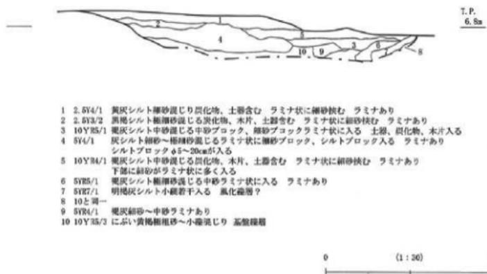
図185 161流路断面図
