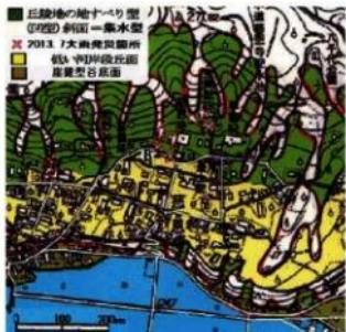
図。作成中の防災図が2013・2020大雨で検定された。上段左図は基図縮尺が1:10,000で集水型斜面を表したが、★印が2013.7.17-18大雨による発災箇所である（図中Bは絵図によれば弁財天の池を埋めた箇所で水みちがあったのである）。中段図1が基図1:2000による水みち(太いオレンジ色線)で2020.7.27-29大雨の発災箇所である。図3は5m格子DEMを利用して作成した凹型斜面格子図である。阿子島功(2021)史跡の保存管理のための地形分類図 西村山地域史の研究38, p. 80-99 阿子島功(2022)史跡保存管理計画における地形分類図の意義(4) 5m格子DEMの利用と限界、日本地理学会予稿集101 P014
