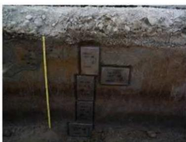
図4 平城京朱雀門周辺の調査（平城第552次）で発見された地震痕跡（液状化構造）に対する地質切取試料採取調査の様子
