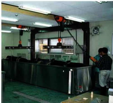
写真4 含浸槽で保存処理中のケヤキ修羅
