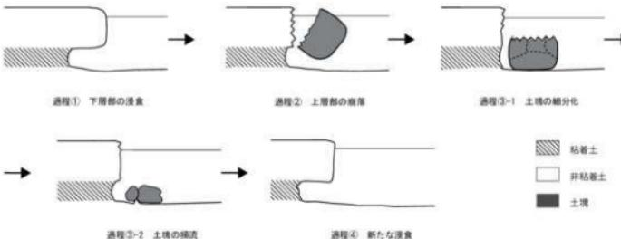
Fig. 308 自然堆積河川の浸食過程
