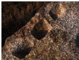
写真10 矢の形の鎖が内側に付着した矢穴
