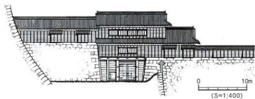
図2 機門推定復元図（西より、河合勤氏作画）※
