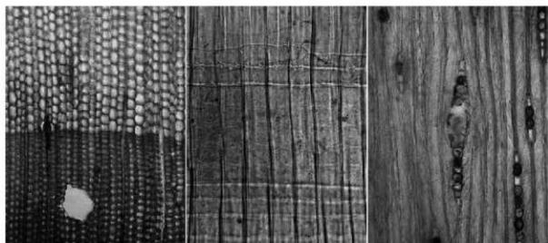
横断面 0.1mm 放射断面 0.1mm 接線断面 0.1mm 写真No.1. マツ属複雑管束亜属 番号20 柱根 4次 番号52(016特3-34) G地区0-I面 E-26区SK1003(SE1013)取上げ⑥
